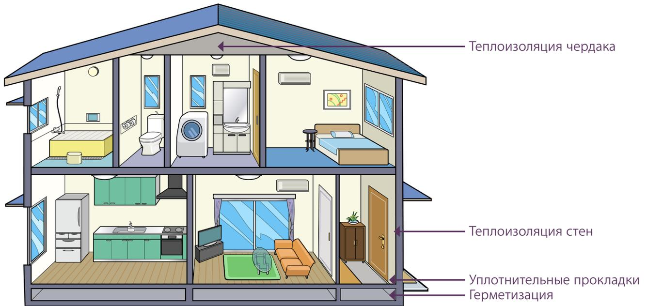
Теплоизоляция - это защита вашего дома, позволяющая предотвратить утечку нагретого или охлажденного воздуха. Теплоизоляция также обеспечивает круглогодичный комфорт и сокращает расходы на отопление и охлаждение дома.
